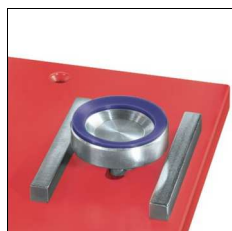
Possibilité d'utiliser les tasseaux à l'envers.
